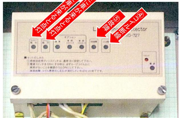
写真8. コイル断線表示と故障表示
